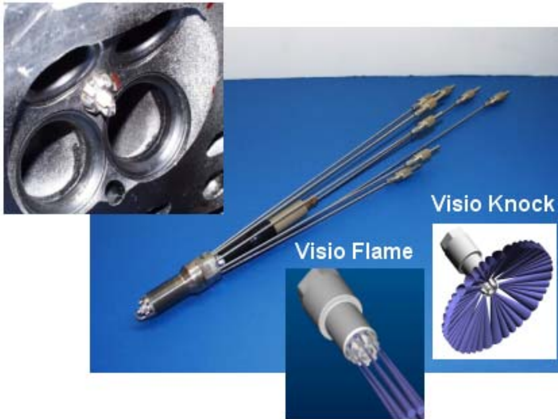
Bild 4: Visioskopie Technik „Visio Flame“ und „Visio Knock“
