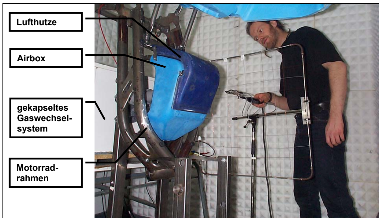
Bild 4: Messaufbau zur Schallquellenortung mittels Intensitätsmesstechnik
