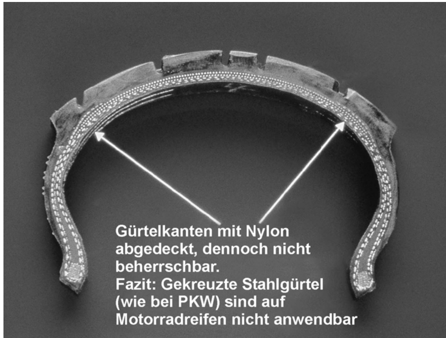
Bild 12: Semiradialreifen mit Nylonabdeckung des konventionellen Stahlgürtels
