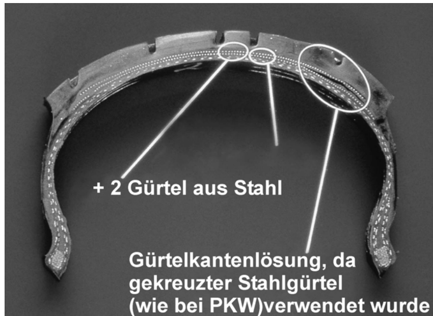
Bild 8: Semiradialreifen mit konventionellem Stahlgürtel
